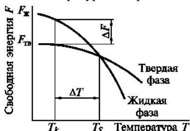
2.11-сурет. Температураға байланысты сұйық ( E_c ) және қатты ( E_k ) металдың бос энергиясының ( F ) өзгеруі:
