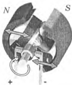
Рис. 25.3. Устройство простейшего коллекторного двигателя постоянного тока с двухполюсным статором и с двухполюсным ротором
