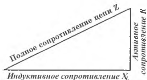
Рис. 16.9. Определение полного сопротивления цепи, содержащей индуктивное и активное сопротивление
